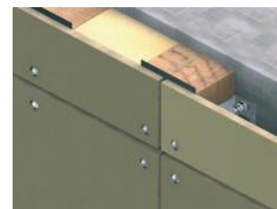
Fibrocemento sobre madera.
