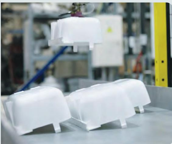
En la actualidad, la plasturgia en SFA son 33 máquinas y un total de 760 moldes. La línea está totalmente automatizada, del transporte de la materia prima de los silos hasta las máquinas y de las máquinas hasta la salida de los productos.
