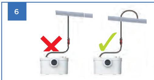
• El tubo de evacuación del triturador deberá estar conectado por la parte superior de la tubería y en el sentido de la evacuación.
