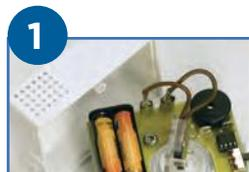
1 Insertar 2 pilas de 1,5 V (no incluidas) en la caja.
