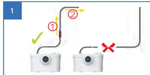
• La elevación vertical debe realizarse al principio del circuito de evacuación (1) y se debe instalar una llave de corte para el mantenimiento. Desde el punto más alto del desagüe (2), se requiere una pendiente al menos del 1%.
