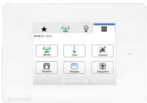
Supervisión y control de los sistemas domótico y antiintrusión
