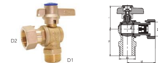
VÁLVULA SALIDA ESCUADRA ROSCA BSP M-H ISO 228/1. Palanca. Tuerca loca. Con retención interior
