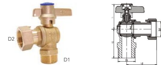
VÁLVULA SALIDA ESCUADRA ROSCA BSP M-H ISO 228/1. Palanca. Tuerca loca. Con retención interior
