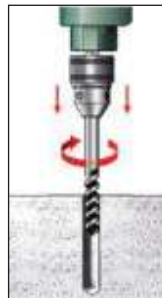
Taladrar con broca de 8 [mm]
