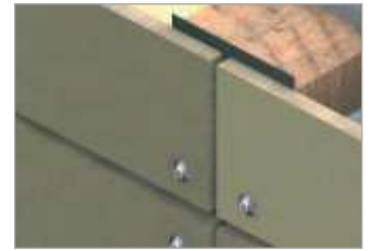
Fibrocemento sobre madera
