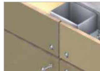
Fibrocemento sobre acero
