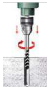
Taladrar con broca de 8 [mm]
