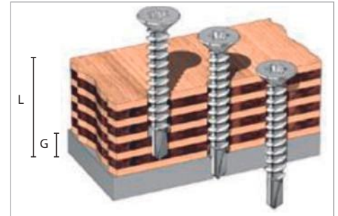
G: Espesor del perfil metálico.C
