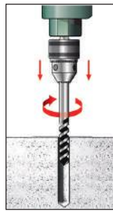
Taladrar con broca de 8 [mm]
