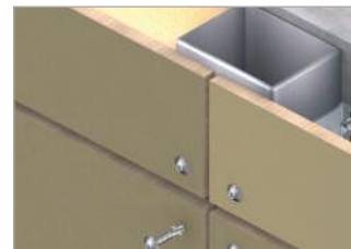
Fibrocemento sobre acero
